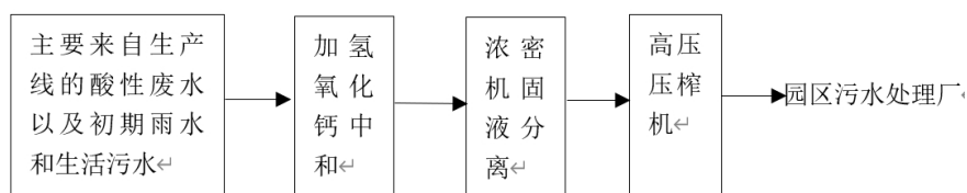
图 5-5 某硫酸法钛白粉企业废水处理工艺流程图
